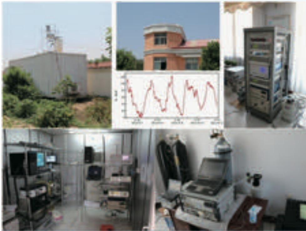
2014年6月5日，国家自然科学基金重点项目“光化学过程对华北区域臭氧和二次气溶胶形成的影响”的野外综合观测试验在河北省衡水展开。首批仪器设备主要探测地面臭氧、气溶胶前体物和光解系数等。综合观测试验由气科院组织，中国气象局气象探测中心、中科院大气物理研究所、部分省气象局以及中国环境科学研究院等协作单位也将参加试验及相关研究工作。
