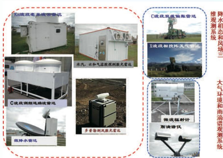
图3 青藏高原云降水外场试验观测主要设备
