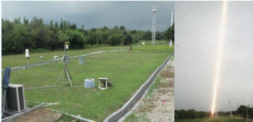
图1 人工引雷试验场（左）和一次成功触发闪电（右）
