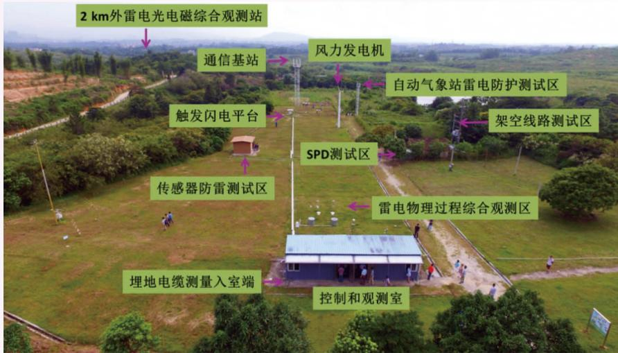
图 1 2015年GCOELD试验中人工引雷试验场的建设和设备布置情况
